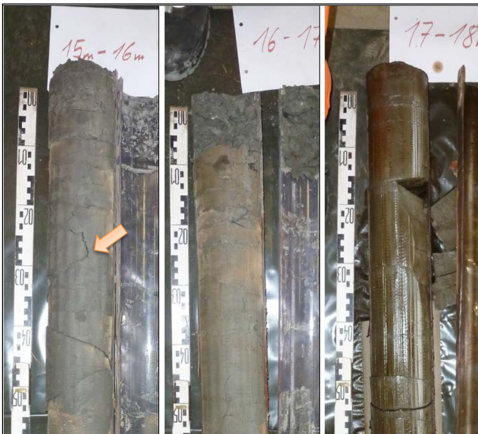
Abb. 18: Bohrkern KB1 im Bereich 15-18 m unter GOK mit steilstehenden Mikrobrüchen (Pfeil links) und Ölführung bei 17-18 m (von der Stein, 2014a).
