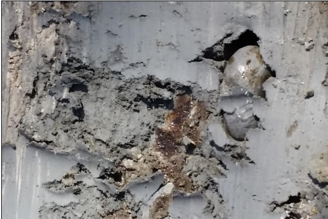
Abb. 10: Tiefschurf 2, Ölaustritte entlang grobkörniger Geschiebe in der Grenzzone Quartär-Geschiebemergel und Unterkreide-Tonstein (Jackelen, 2015).
